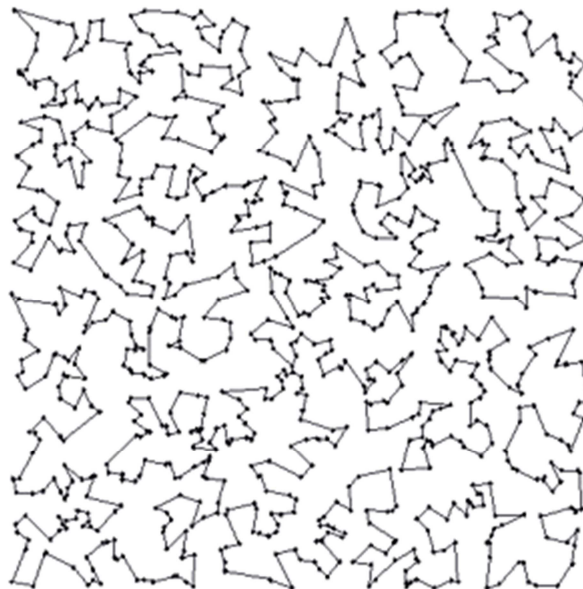
Schéma 1 : représentation du chemin le plus court passant par une distribution aléatoire de 1000 points.
